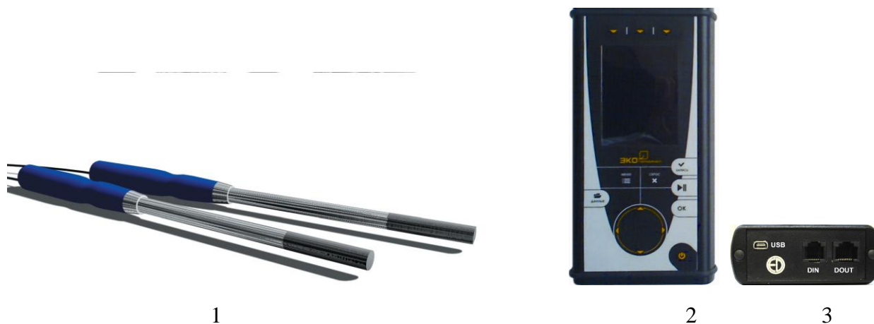
Рисунок 1 – Общий вид измерителя 1 – измерительные зонды, 2 – индикаторный блок (лицевая панель); 3 – индикаторный блок (вид снизу)
