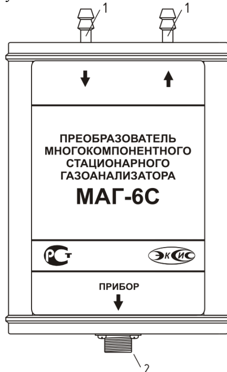
Рисунок 3.14 Измерительный преобразователь прибора МАГ-6 С 1 – газовые штуцера («вход» и «выход» соответственно); 2 – разъем для подключения к прибору
